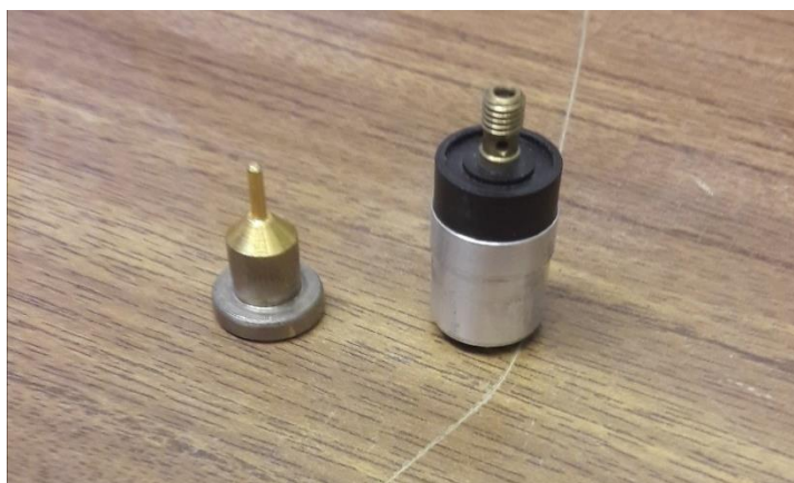
Рис. 2.2: Сигнальный колпачок (слева) и эндплаг (справа)
