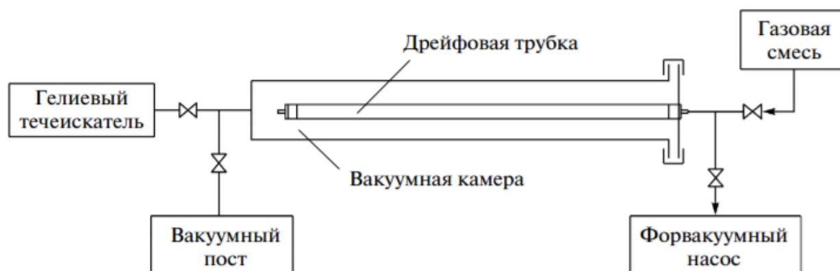
Рис. 4.11: Схема установки для испытаний на герметичность.
