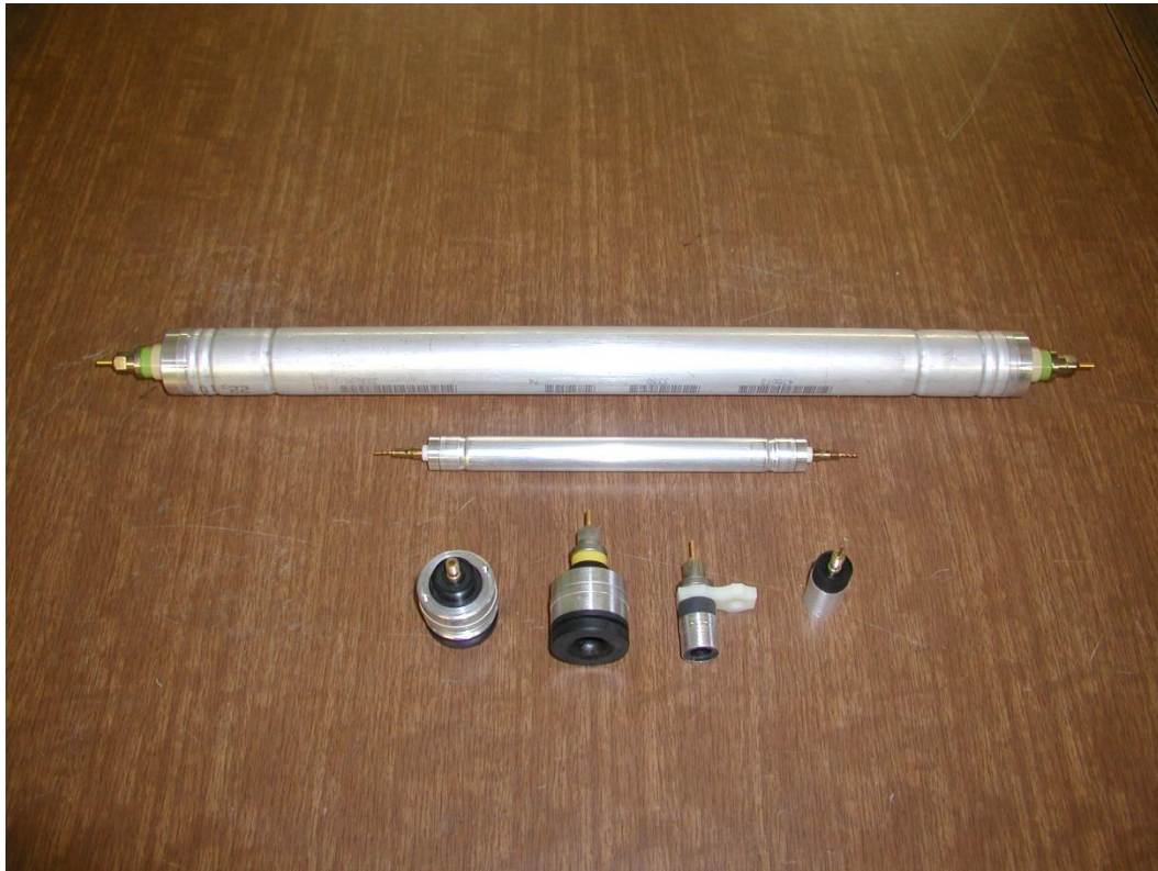
Рис. 1.1: 30 и 15-миллиметровая дрейфовые трубки и торцевые заглушки (эндплагги)
