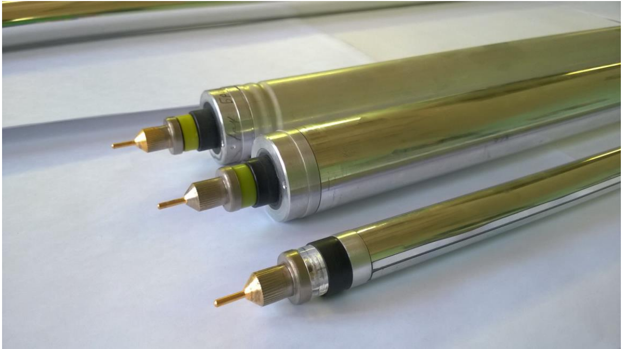
Рис. 3.2: 30-миллиметровая алюминиевая и лавсановая трубки, 15-миллиметровая лавсановая трубка
