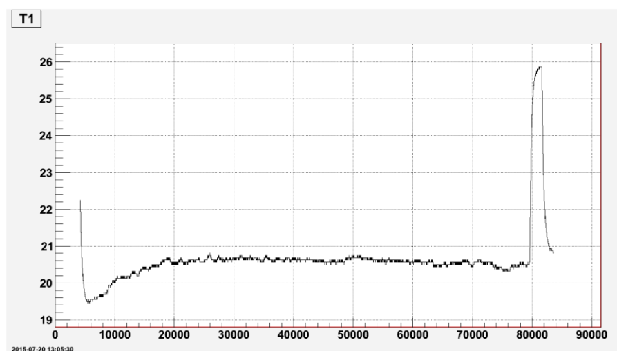
Рисунок 21. Зависимость температуры от времени с выключенным и включенном элементом Пельтье на датчике 1
