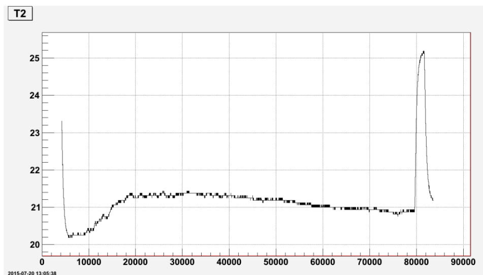
Рисунок 22. Зависимость температуры от времени с выключенным и включенном элементом Пельтье на датчике 2.
