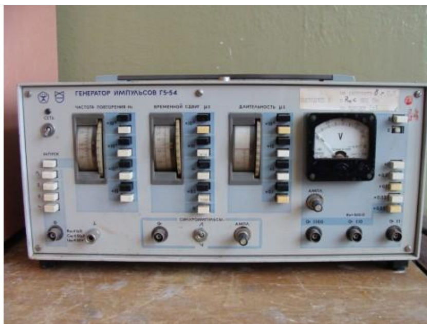
Рисунок 12. Генератор импульсов Г5-54 .
