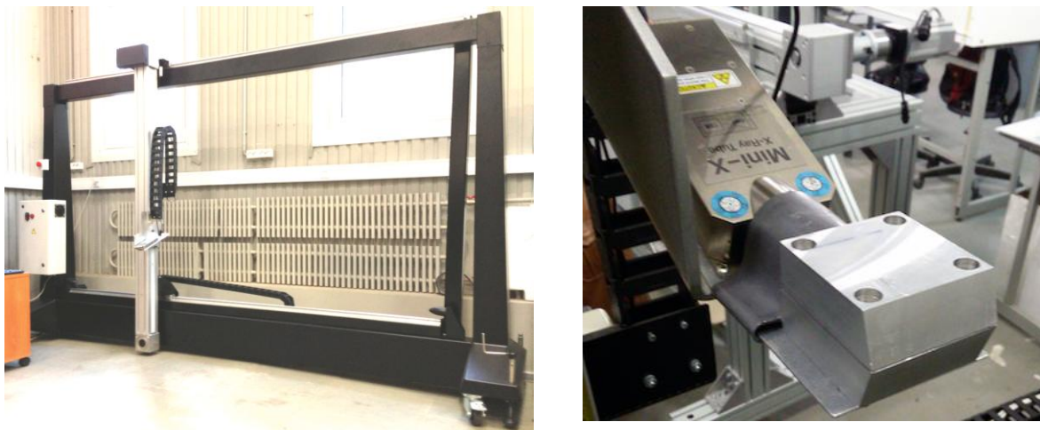
Рисунок 12 - Фотографии рентгеновского стенда (слева) и рентгеновской трубки Мини-Х.
