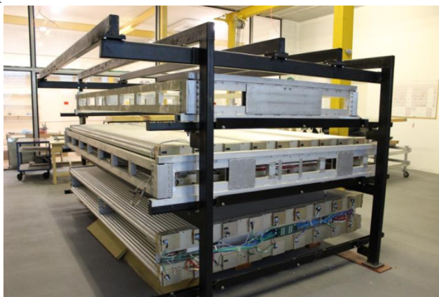
Рисунок 2 - Стенд проверки МИК на космических мюонах
