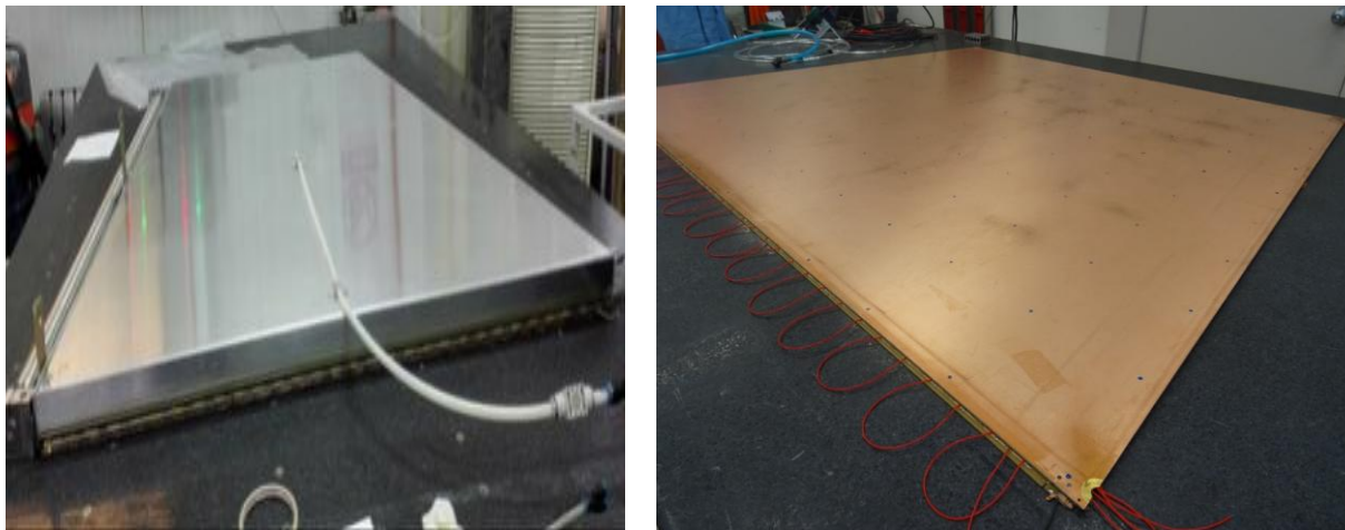
Рисунок 11 - На фотографии слева показана операция склейки однослойной ТЗК. Видна плита из алюминиевого сотового материала, положенная на гранитный стол. Между плитой и столом находится склеиваемый слой ТЗК. На фотографии справа показана однослойная ТЗК после процедуры склейки.
