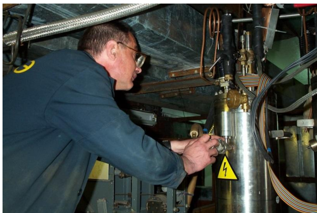
Рисунок 26 - Установка криостата с прототипом модулей на пучок протонов канала №23 ускорителя ИФВЭ.
