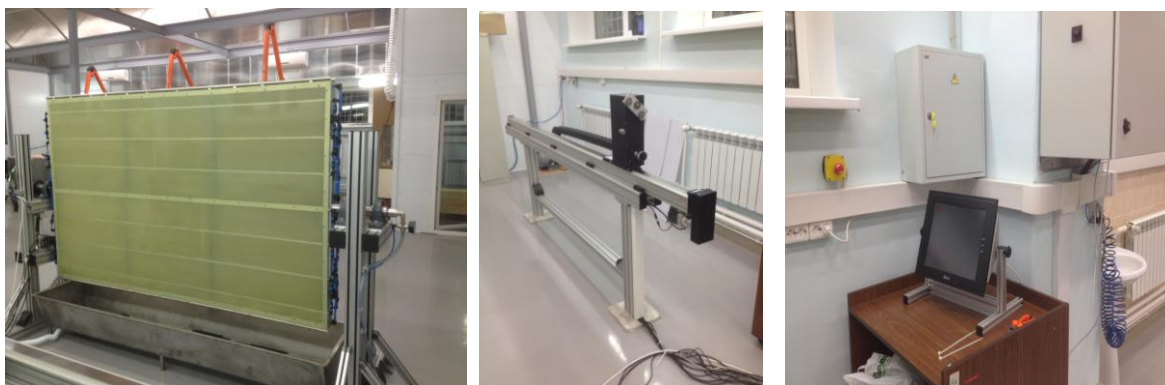
Рисунок 1 - Устройство для натяжения и намотки анодных проволок ТЗК камер. Слева показан намоточный стол с вакуумным прижимом катодных плат. В центре, показана система перемещения с установленным на ней устройством для натяжения и подачи проволоки. На правой фотографии виден шкаф управления и дисплей, через который осуществляется управление устройством.
