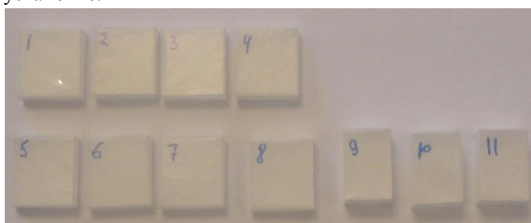
Рисунок 30 - Образцы сцинтилляторов UPS и EJ-200, готовых к облучению на канале №3 реактора ИБР-2.
