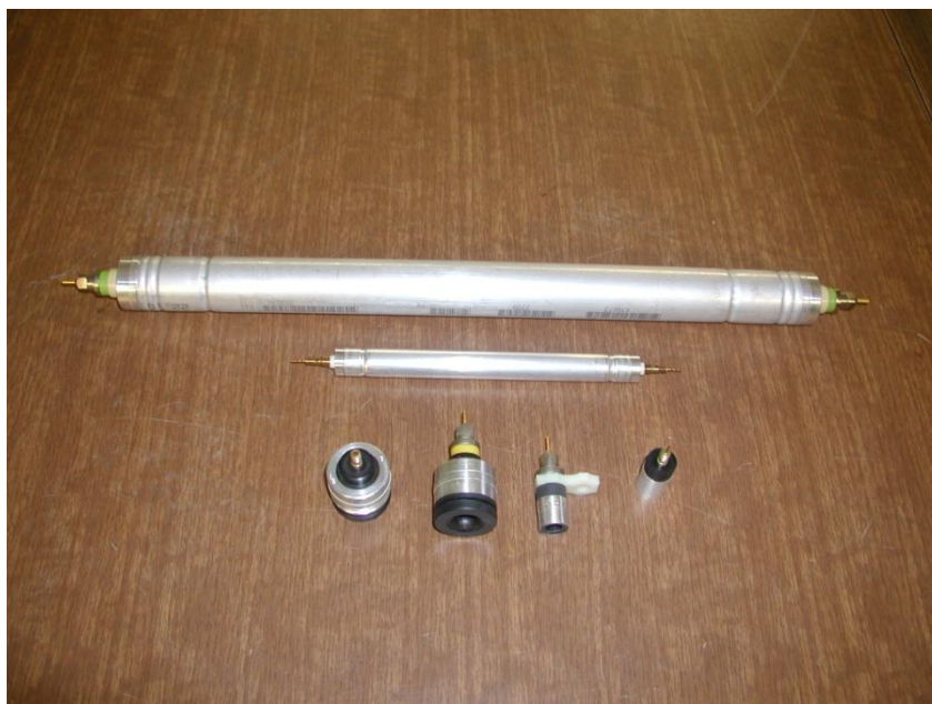
Рисунок 18 - Фотография дрейфовой трубки диаметром 30 мм, лабораторного образца ДТМ ( \varnothing 15 мм) и соответствующих им торцевых заглушек.
