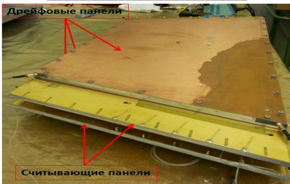
Рисунок 6 – Фотографии ряда этапов склейки панелей и собранного квадруплета
