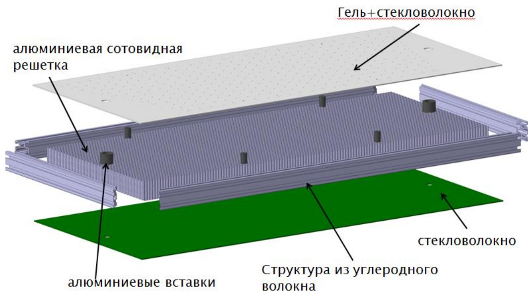
Рисунок 2 - Структура вакуумного стола
