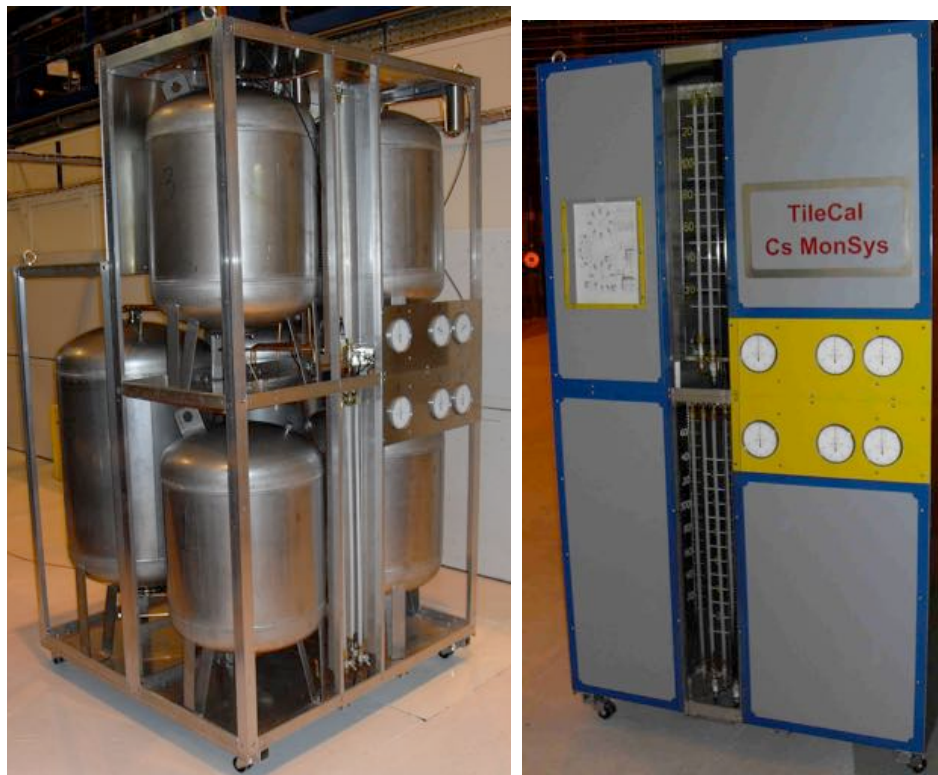
Рис. 2.16. Станция хранения жидкости (WS) состоящая из двух сосудов по 230 литров и четырёх по 130 литров, скомбинированных в пары для хранения жидкости и сбора вытесняемого воздуха
